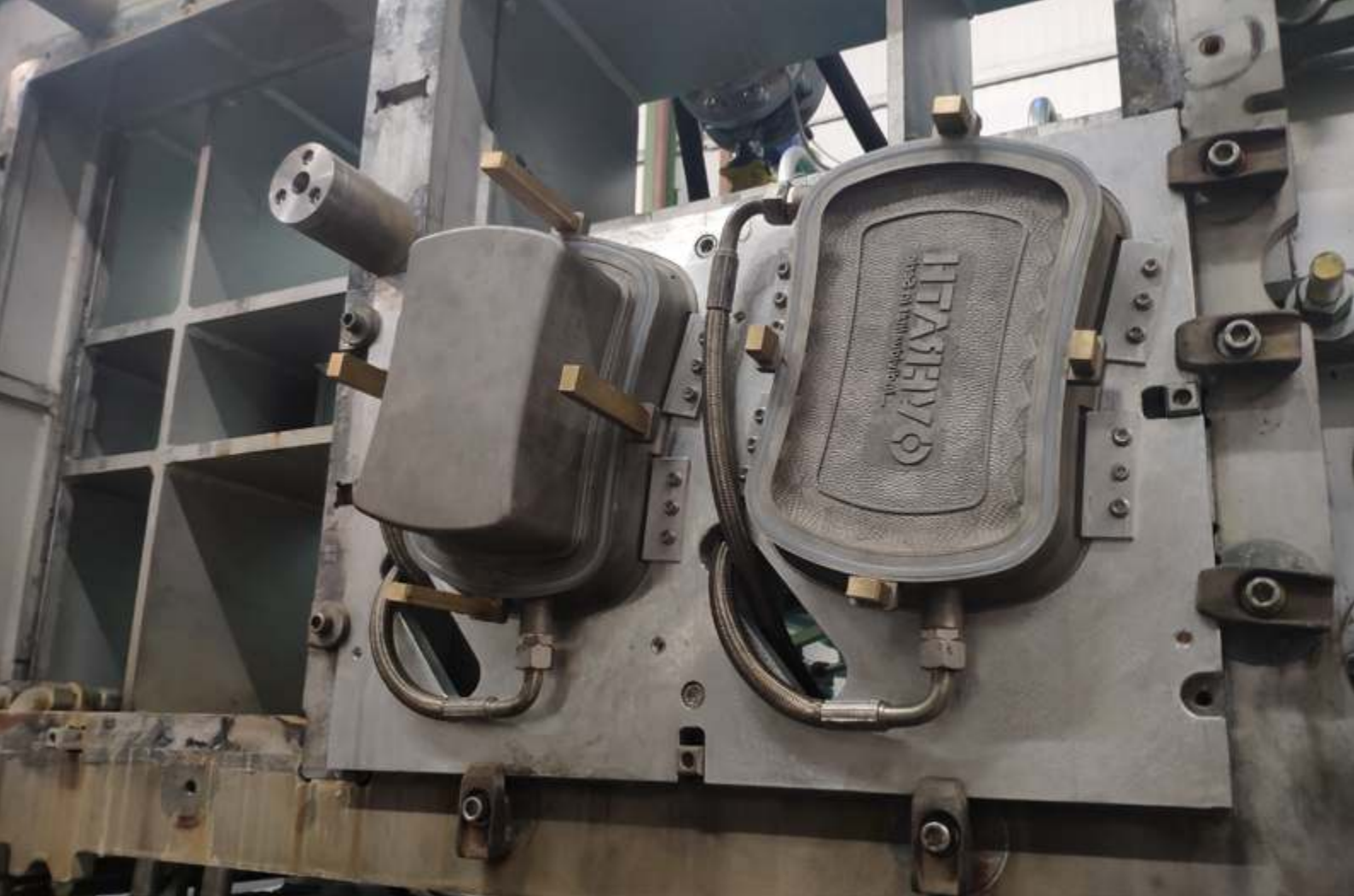
Abbildung 10: SLM-Werkzeugkavität Lunchbox. Quelle: Overath
