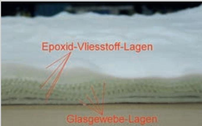
Abb. 3: Lagenaufbau vor dem Pressvorgang
