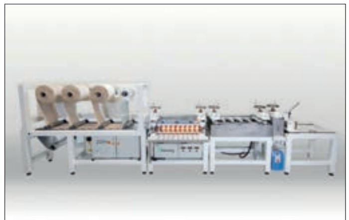
Abb. 1: Gemeinsam von der DIRKRA Sondermaschinenbau GmbH und dem Fraunhofer IPT entwickelte Produktionsanlage zur kontinuierlichen Konsolidierung von Faser-Metall-Laminaten
