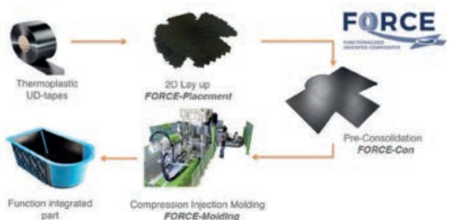
Abb. 1: FORCE – Verarbeitungskette für endlosfaserverstärkte thermoplastische Faserverbundbauteile bei der Neue Materialien Bayreuth GmbH
