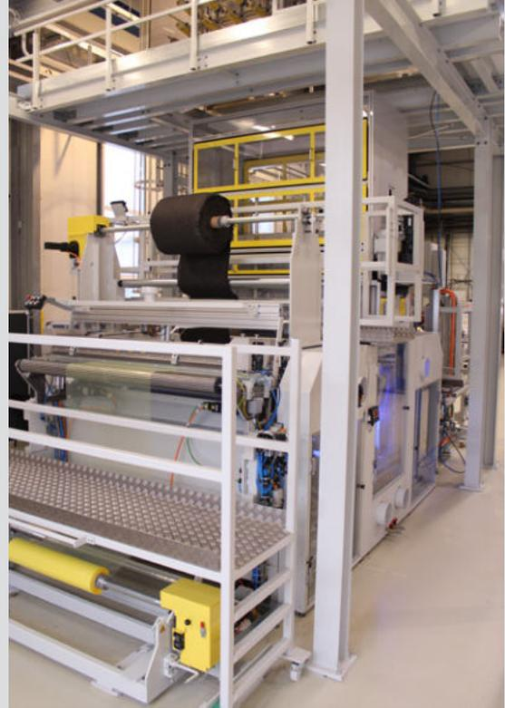
Abb. 2: SMC-Bandanlage am Fraunhofer ICT
