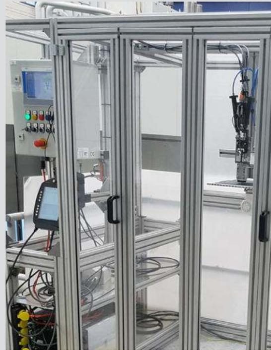
*Abb. 1: Automatisierte Fertigungszelle für den 3D-Druck von endlosfaserverstärkten Verbundbauteilen*
