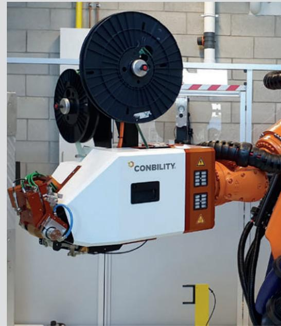
Herstellung von Tailored Blanks mit unterschiedlichen Wandstärken innerhalb eines Laminats.
