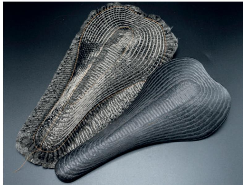
Abb. 1 Fahrradsattel - Preform und finales Bauteil
