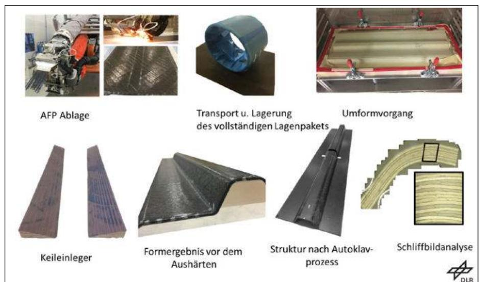
durch Omega-förmige Stringer effizient geformt werden können. Da die vollständigen Stringerlaminare aus Prepreg eben abgelegt werden, wird die etablierte AFP Technologie zielführend eingesetzt, wobei durch Zusammenführung mehrerer Strin-
